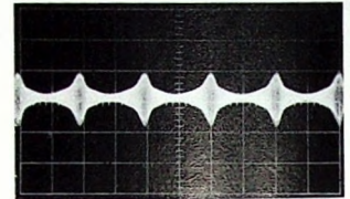
Bild 5. Modulationshüllkurve an der Mischstufenbasis bei ungenügend sperrender Vorstufe; m = 80\% am Meßsender
