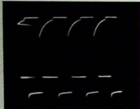
Bild 65. Kurvenformen bei einem Pentodenmultivibrator. Oberes Bild: Spannungsform am Gitter; unteres Bild: Spannungsform am Schirmgitter. Infolge Umladung schädlicher Kapazitäten treten hier Zipfel im unteren Teil der Kurve auf
