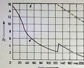
Bild 7 (oben). Abschaltcharakteristik der Kurzschlußautomatik (Kurve a) und der trägen 2-A-Sicherung (Kurve b)
